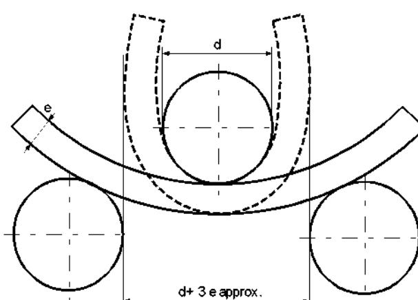
Dijagram ispitivanja savijanjem
