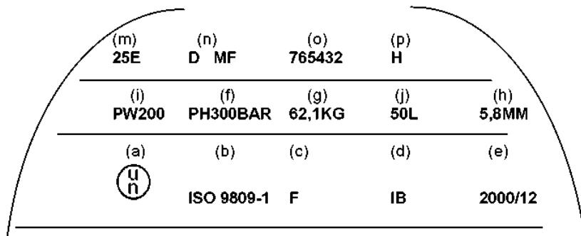
6.2.2.7.6 Druge oznake dopuštene su na svim površinama osim bočnih stjenki pod uvjetom da su izrađene na površinama niskog naprezanja te da su takve veličine i dubine da ne stvaraju štetnu koncentraciju naprezanja. Kod zatvorenih kriogenih posuda takve oznake mogu se postaviti na zasebnu ploču pričvršćenu na vanjski omotač. Takve oznake ne smiju biti u nesuglasju s propisanim oznakama.
